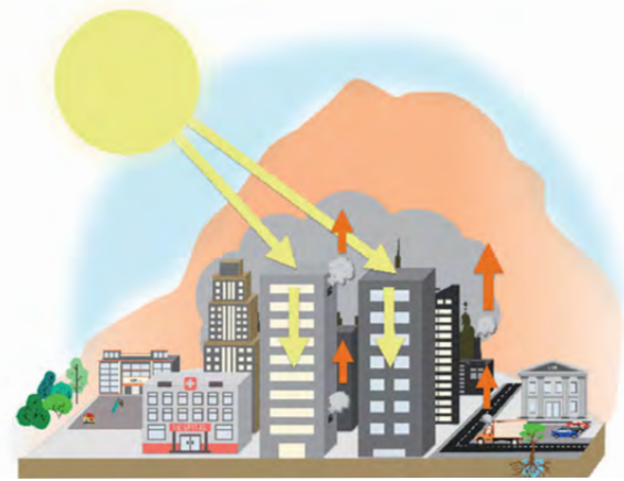
Figure 3 : Illustration des sources de chaleur et des échanges thermiques dans une zone urbaine, durant la journée.
