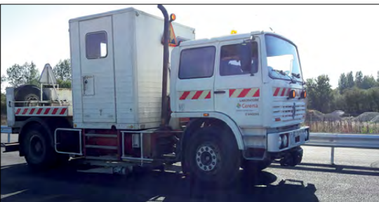
Figure 2.4 : Mesures de déflexion avec déflectographe Lacroix 02 Source : Université Gustave Eiffel
