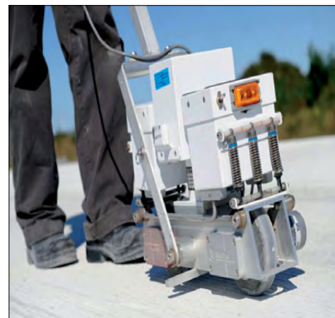
Figure 2 : Le SurPro, un exemple d'un profilomètre dit à bas rendement
