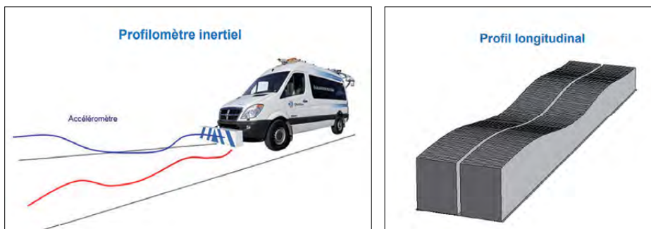
Figure 1 : Principe du relevé de profil (à gauche), et coupe longitudinale, correspondant au profil (à droite)
