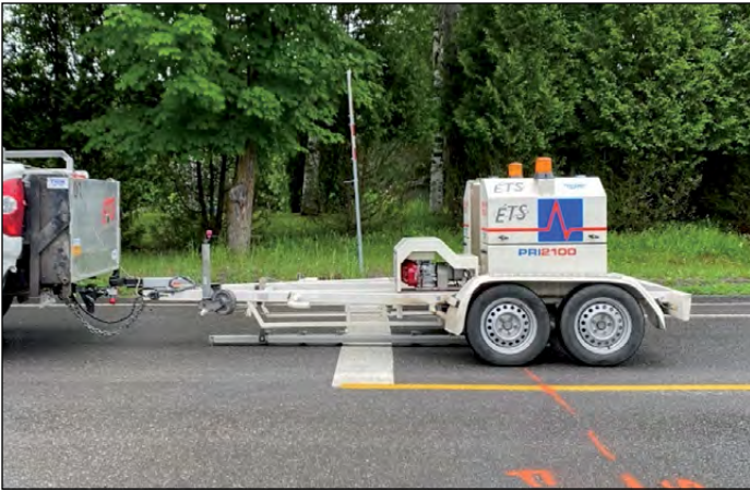
Figure 3 : Mesure de la capacité portante par déflectomètre à masse tombante
