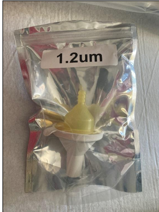
Figure 9. Paquet de filtration ADNe stérile avec filtre autodessiccant intégré
