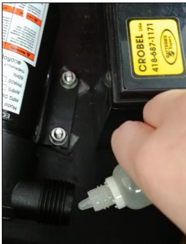
Figure 12. Préparation de la pompe avec l'ajout d'huile
